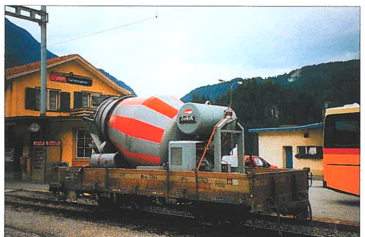
RhB: Kk-w 7344 mit Aluminiumbordwänden (gerade neu als LGB-Modell 40090) hat einen Zementmischer als Ladegut in Tiefencastel. Foto: Sven Linden
