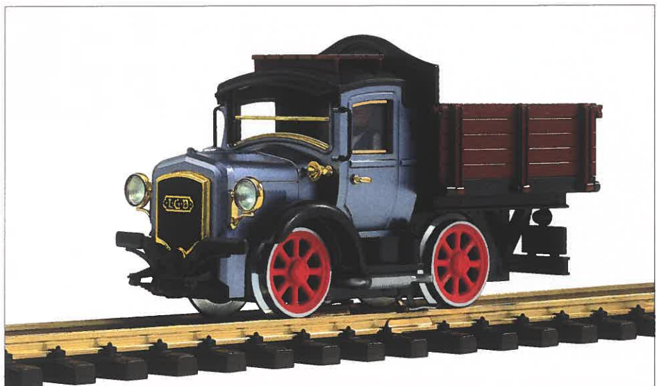
HALLO-Pritschenwagen (22680): Solche Gleisfahrzeuge gab es bei Klein- und Schmalspurbahnen, wo sie für Bahndienstzwecke verwendet wurden. Das Modell ist eine feine Nachbildung mit großer Motorhaube und verziertem Kühlergrill, beleuchteten Scheinwerfern, eingerichtetem Fahrerhaus und offener Ladepritsche.
