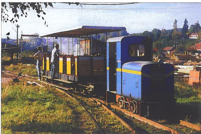
Die Deutz-Feldbahnlok fährt am Saisonende alle Wagen einzeln zur Remise. Der Personensommerwagen ist ein Eigenbau auf ehemaligen Waldbahnuntergestellen.
