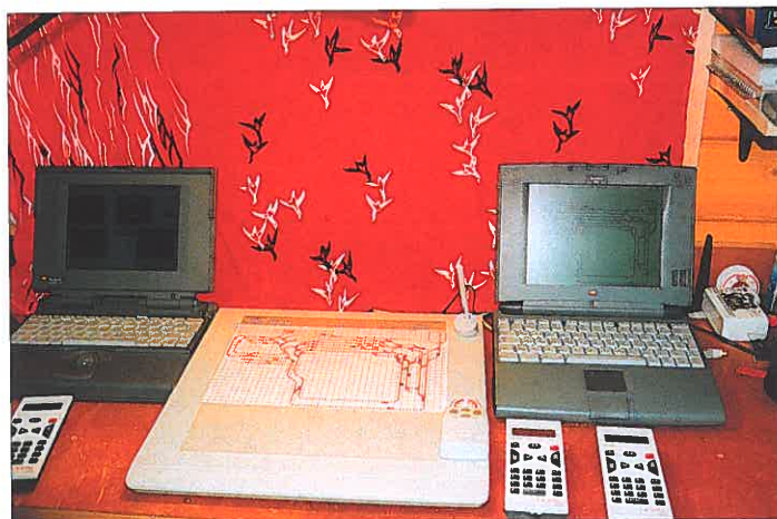
Zwei Apple-Notebooks, Lenz-Handregler und Digitalisierungstablent bilden das Stellwerk.
